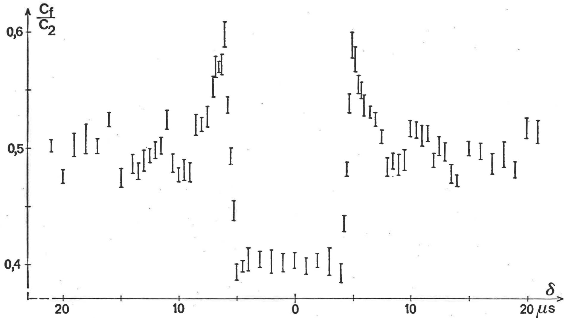
Fig.3 - Rapport des taux de coïncidences fortuites  $C_f$  et de coïncidences vraies  $C_2$  en fonction du retard  $\delta$  entre les voies  $\beta$  et  $\gamma$ . Ces simulations par Monte Carlo se basent sur les valeurs  $B_1 = G_1 = 200\,000\text{ s}^{-1}$ ,  $C_1 = 100\,000\text{ s}^{-1}$ ,  $\tau_p = \tau_\gamma = 5\mu s$  et  $\tau_r = 1\mu s$
