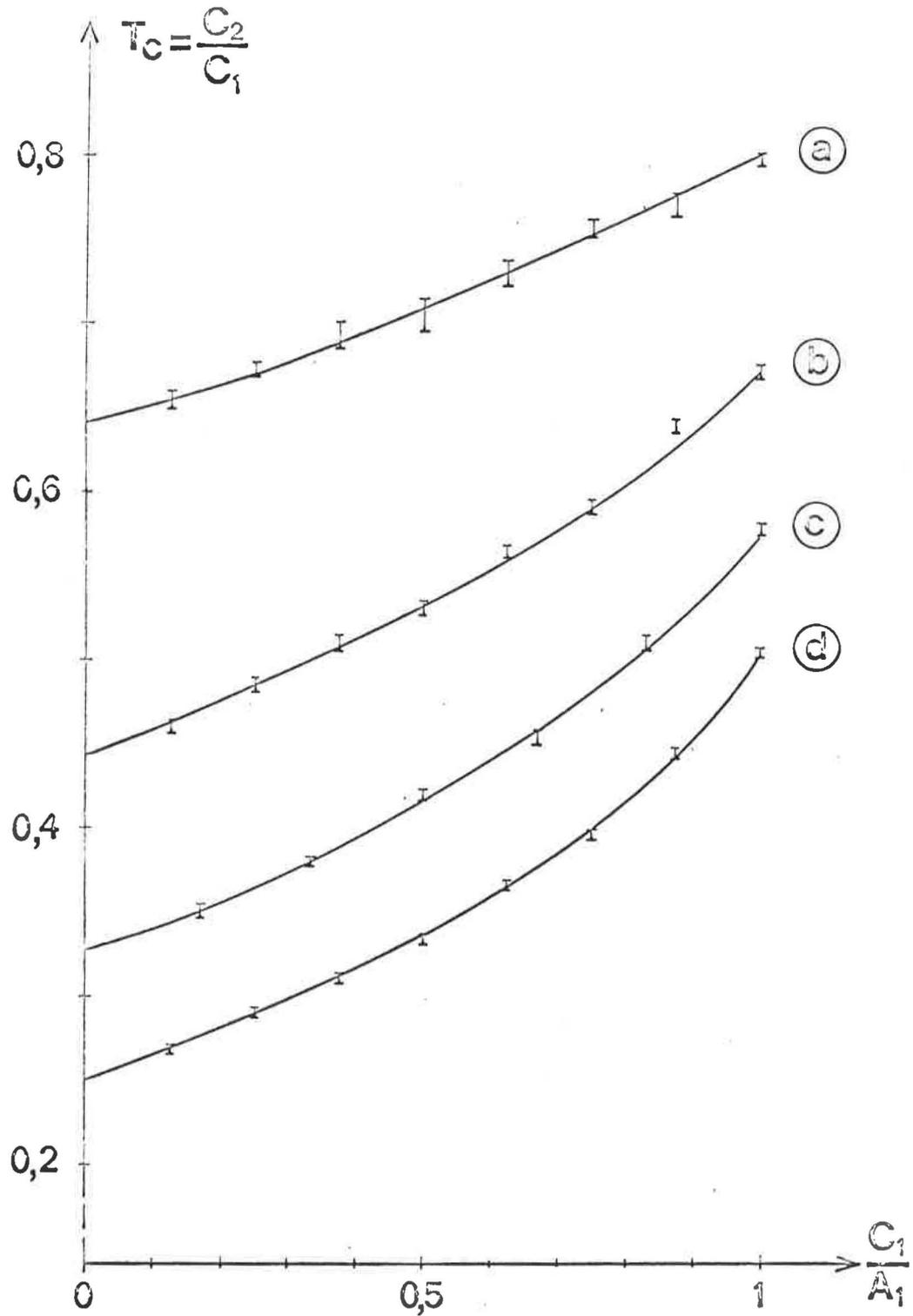
Fig. 2 - Facteur de transmission  $T_c$  pour les coïncidences vraies en fonction du rapport  $C_1/A_1$  des taux de comptage, avec  $A_1 = \min(B_1, G_1)$ .
