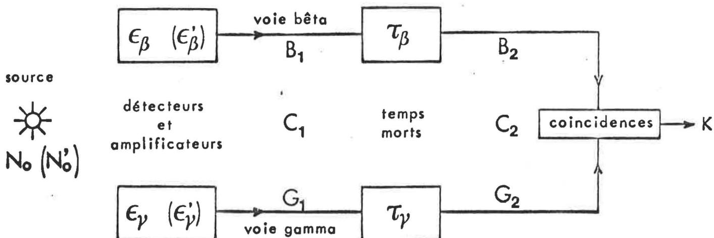
Fig. 1 - Schéma de principe (simplifié) pour la méthode  $4\pi\beta\text{-}\gamma$  avec les taux de comptage correspondants. Les quantités entre parenthèses se réfèrent au mouvement propre.
