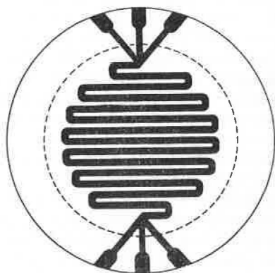
Fig. 2. — Élément chauffant du nouveau modèle de radiomètre « type Guild ».
