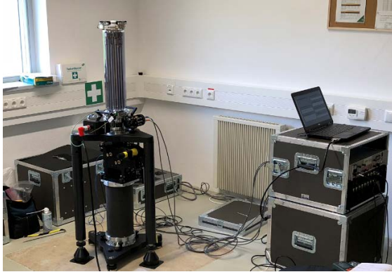
Fig. 9a. Absolute gravimeter FG5-X
