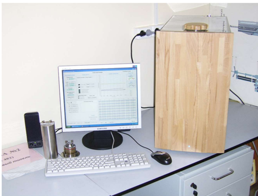
Fig. 1 The photograph of Bomb Calorimeter «VIM»
