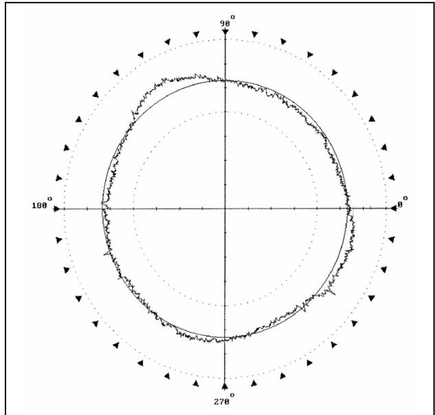
**Fig. C6.** 3.465 mm plug. Scale= 0.1 μm
