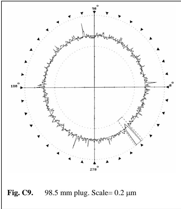
**Fig. C9.** 98.5 mm plug. Scale= 0.2 μm
