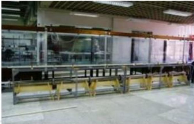
Túnel Estratificado-Poço Horizontal
