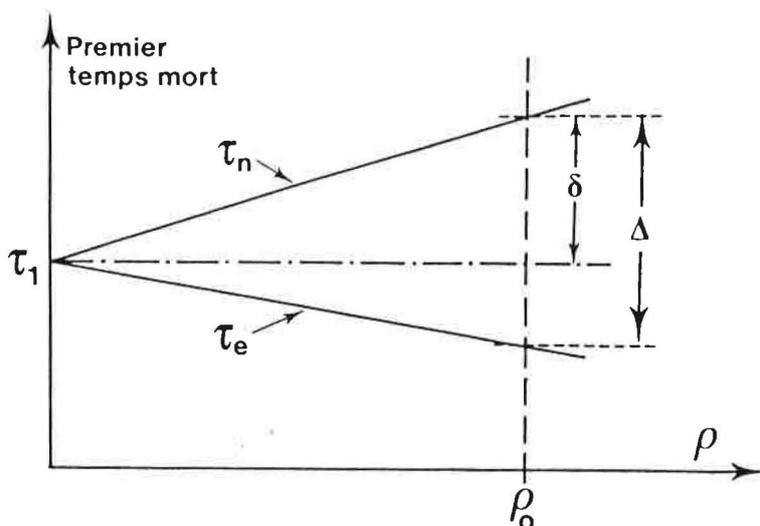
Figure 2 - Représentation schématique des résultats de la mesure d'un temps mort  $\tau_1$  du type général d'Albert et Nelson que l'on interprète comme s'il suivait un des deux types habituels. Dans cette approximation on a  $\delta = \rho_0 \tau_1^2 / 2$  et  $\Delta = \rho_0 \tau_1^2 / 2$ .
