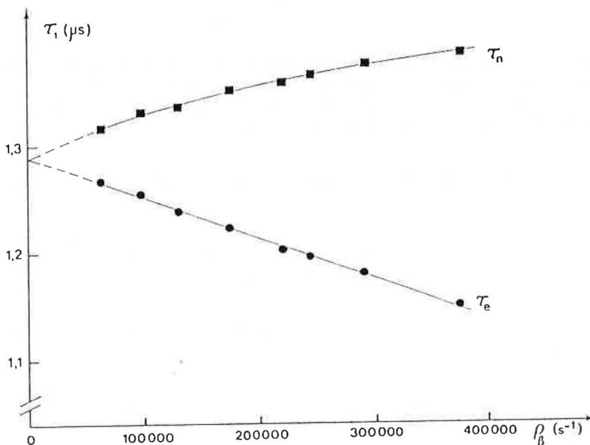
Figure 1 - Comportement de la valeur déduite pour le premier temps mort  $\tau_1$  de notre appareillage, supposé du type étendu (e) ou non étendu (n).
