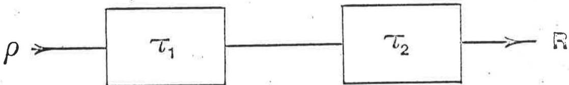
Fig. 7. - Dispositif schématique pour les deux temps morts en série.
