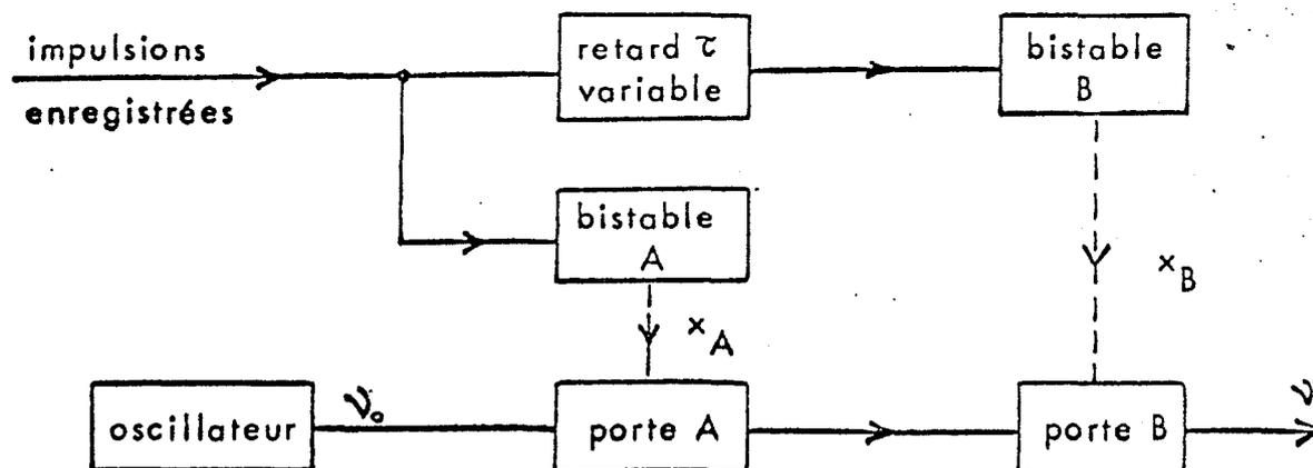
Dispositif schématique pour la mesure de la fonction d'autocorrélation,  $R(\tau)$
