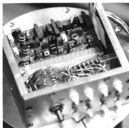
Fig. 3.- Boîte contenant l'électronique et l'inverseur.
