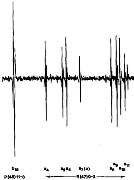
Fig. 5. — Spectre d'absorption saturée (troisième harmonique) de composantes hyperfines de deux raies de  $^{127}I_2$  à  $\lambda = 612$  nm (laser à He-Ne à cuve externe).
